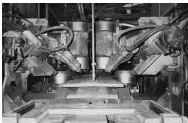
写真 - 1 I桁鋼組立装置(ローラー改造前)
