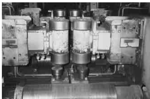
写真 - 2 I桁鋼組立装置(ローラー改造後)
